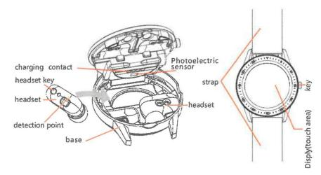
Charging contact: contatti di ricarica Headset key: pulsante di controllo delle cuffie
