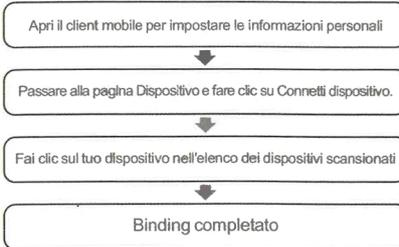
Quando l'interfaccia dell'orologio è premuta per un lungo periodo, verrà visualizzato l'indirizzo MAC dell'orologio e il dispositivo può essere determinato dall'indirizzo MAC nell'elenco dei dispositivi. Una volta completato il binding dell'orologio, ogni volta che si apre il cliente, l'orologio si conatterà automaticamente al telefono cellulare e sarà possibile accedere ai dati abbassando la pagina dei dati del cliente.
