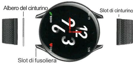
Inserire l'asta della cinghia nella fessura della cinghia, inserire prima un lato nella fessura della fusoliera due, premere l'asta della cinghia dell'altro lato verso il basso con il dito e premere saldamente l'albero della cinghia sulla fusoliera.
