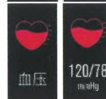
6. Mesure de la pression artérielle, entrez dans le mode pression artérielle de l'interface santé et lancez la mesure. Après la mesure, le bracelet affiche les résultats. Si aucune opération n'est effectuée pendant 60 secondes, l'écran s'éteint automatiquement et le bracelet passe en mode veille..
