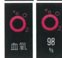
7. Test d'oxygène sanguin, entrez dans le mode d'oxygène sanguin de l'interface santé et lancez la mesure. Après la mesure, le bracelet affiche les résultats. Si aucune opération n'est effectuée pendant 60 secondes, l'écran s'éteint automatiquement et le bracelet passe en mode veille..
