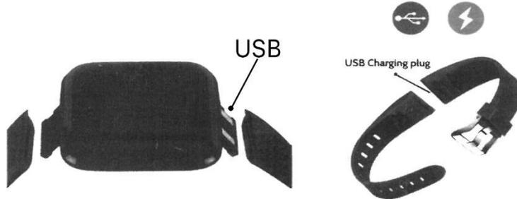
Retire la correa del lateral correspondiente (como ve en la imagen, USB). Conecte la pulsera a un cargador USB, vigilando que haga contacto con los pines metálicos.
