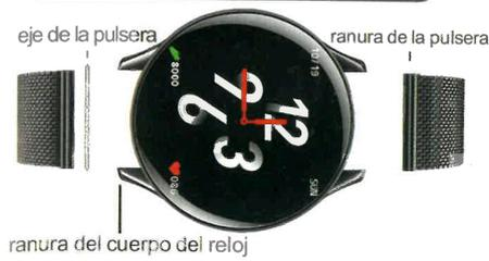
Inserte el eje de la pulsera en la ranura de la pulsera, y ponga el extremo del eje en la ranura a ambos lados de del cuerpo del reloj, presionando el otro extremo del eje con su dedo hacia abajo para ajustarse al cuerpo.
